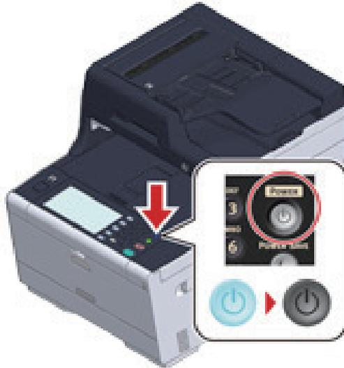
2 “시스템이 종료됩니다. 상태 LED가 깜박거릴 때 상태를 확인하십시오.”라는 메시지가 터치 패널에 표시되며, 전원 스위치 LED 램프는 약 1초 간격으로 점멸됩니다.
