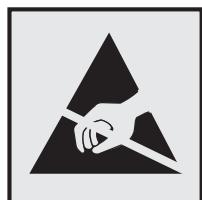
이 기호는 정전기에 민감한 부품을 나타냅니다. 먼저 기호에서 멀리 떨어진 영역의 금속 표면을 만진 후에만 이 기호 주변 영역을 만질 수 있습니다. 용지 걸림 제거나 소모품 교체와 같은 유지 보수 작업을 수행할 때 정전기로 인한 손상을 방지하려면 기호가 표시되어 있지 않더라도 프린터의 내부 영역에 접근하거나 만지기 전에 프린터의 금속 프레임을 먼저 만지십시오.
